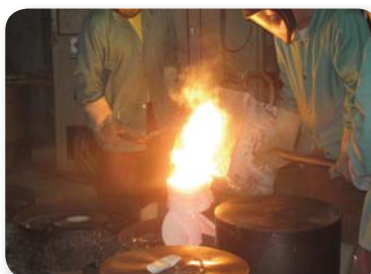
Pouring molten steel
